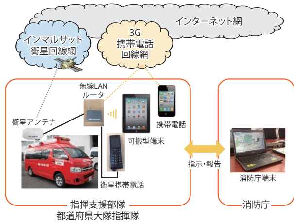
特集1-2図 緊急消防援助隊動態情報システムの概要図
