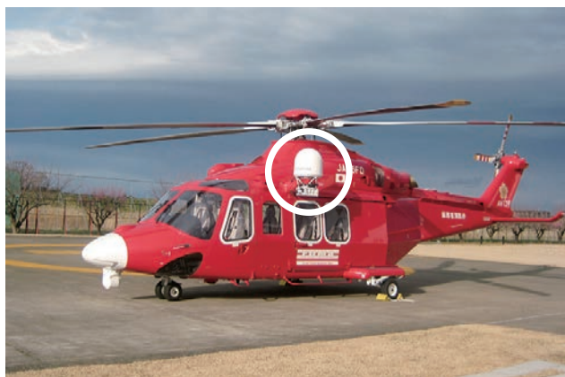
ヘリサットアンテナの搭載状況 (消防庁ヘリコプター5号機)
